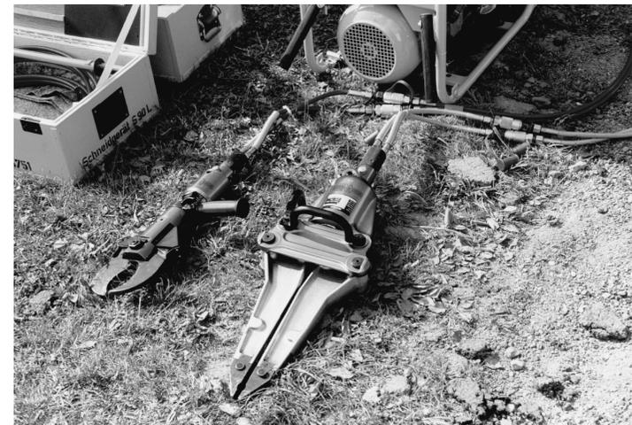
Rettungsspreizer und Schneidgerät der FFW Neusorg
